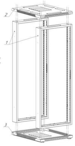
1. Соединить крышку поз. 2 и дно поз. 3 с рамами поз. 1 с помощью винтов с гайками.
