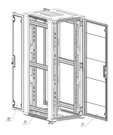
7. Установить переднюю дверь поз. 9 и задние двери поз. 10 и 11 петлями в отверстия в дне и крыше.
